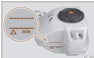
Obr. 2 V předním prostoru: Vyrovnávací nádobka chladicí kapaliny.
