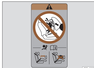
Obr. 33 Nálepka pro airbag na sloupku B.
