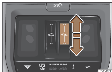
Obr. 92 Ve stropním panelu: ovládání protisluneční rolety.
