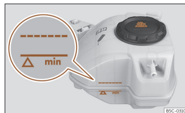
Obr. 229 V předním prostoru: Vyrovnávací nádobka chladicí kapaliny.
