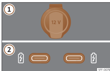
Obr. 176 12voltové zásuvky ve vozidle
