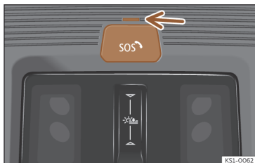
Obr. 34 Ve stropní konzole: tlačítko tísňového volání eCall (za krytem tlačítka) a kontrolka (šipka).
