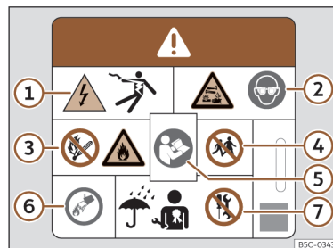
Obr. 49 Výstražná tabulka na vysokonapěťovém akumulátoru.
