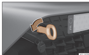
Obr. 42 Přední nárazník vpravo: zašroubované vlečné oko
