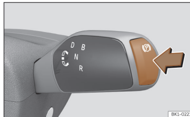
Obr. 31 Na spínači jízdních stupňů: tlačítko elektronické parkovací brzdy.
