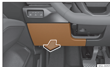
Obr. 37 Na straně řidiče v přístrojové desce: kryt pojistkové skříňky.
