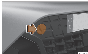
Obr. 41 Na pravé straně předního nárazníku: odstranění krytu.
