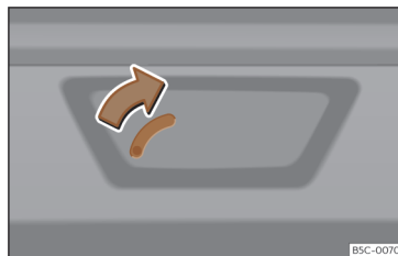
Obr. 17 Detail zavazadlového prostoru: nouzové odjištění.
