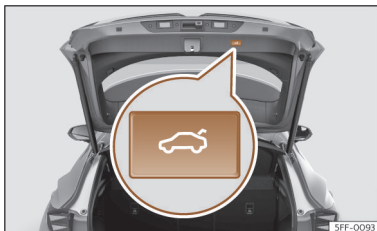
Obr. 16 Zadní víko: tlačítko pro zavírání zadního víka.
