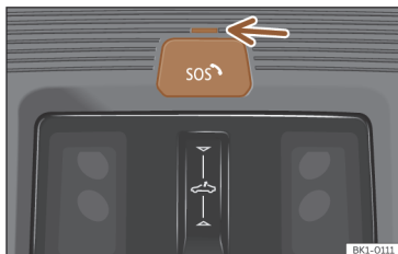
Obr. 42 Ve stropní konzole: tlačítko tísňového volání eCall (za krytem tlačítka) a kontrolka (šipka).
