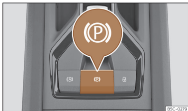
Obr. 36 Na středové konzole: tlačítko elektronické parkovací brzdy.
