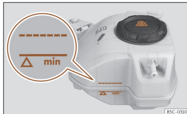
Obr. 225 V předním prostoru: Vyrovnávací nádobka chladicí kapaliny.
