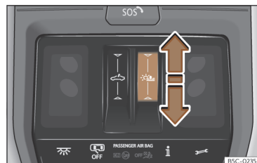
Obr. 92 Ve stropním panelu: ovládání protisluneční rolety.
