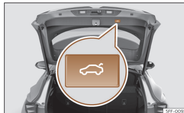
Obr. 82 Zadní víko: tlačítko pro zavírání zadního víka.
