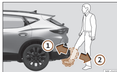
Obr. 84 Zadní víko se snímači řízeným otvíráním a zavíráním (Easy Open).
