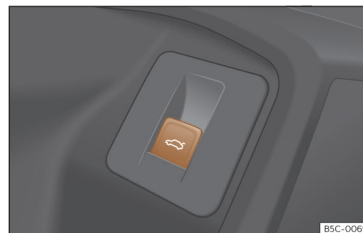
Obr. 83 Na dveřích řidiče: tlačítko pro otvírání a zavírání zadního víka.
