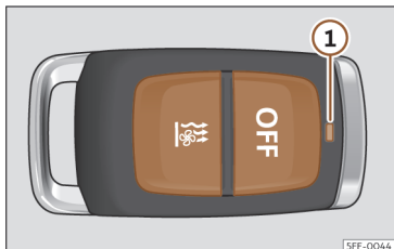
Obr. 117 Nezávislé topení: s rádiovým dálkovým ovládáním.
