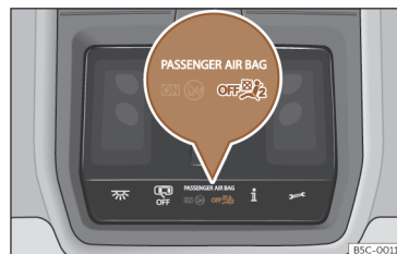
Obr. 28 Ve stropní konzole: kontrolka odpojení airbagu na straně spolujezdce.
