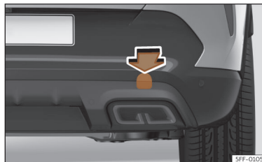
Obr. 210 Na pravé straně zadního nárazníku: odstranění krytu.
