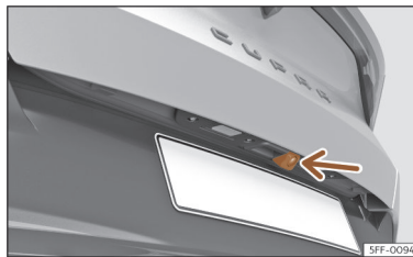
Obr. 133 V rukojeti zadního víka: montážní místo zpětné kamery.
