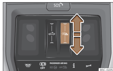
Obr. 90 Ve stropním panelu: ovládání protisluneční rolety.
