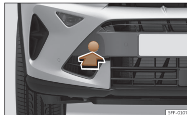
Obr. 208 Na pravé straně předního nárazníku: odstranění krytu.
