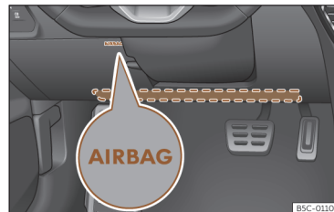
Obr. 34 Na straně řidiče: montážní místo kolenního airbagu.
